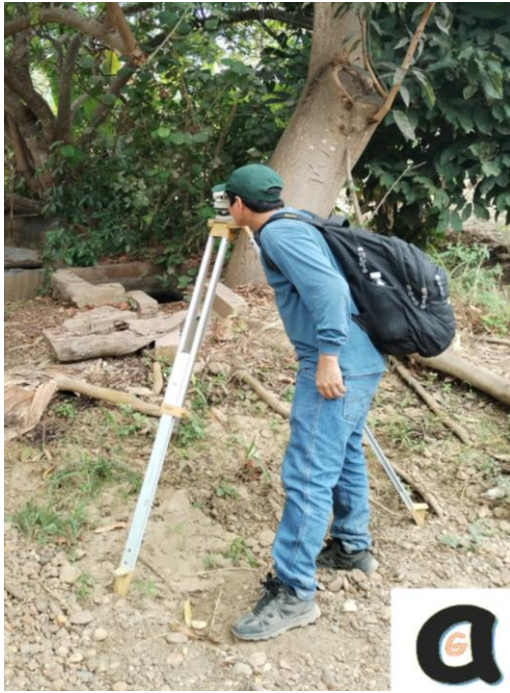
Fotografía de trabajo topográfico Trabajo de nivelación de pozo en estudio N°2
