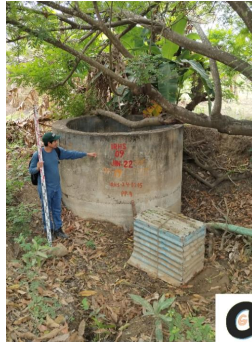
Fotografía de trabajo topográfico Trabajo de nivelación de pozo en estudio N°2
