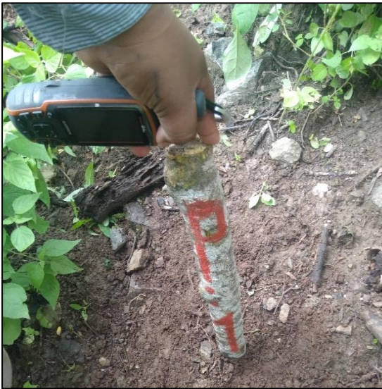
Imagen N° 17. Georreferenciación (Punto) de cada estaca con GPS Germin 64s, en cada una de las parcelas de muestreo.
