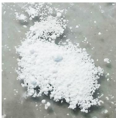
**Figura 4** Nanopartículas de ZnO sintetizadas a la temperatura de 30°C.
