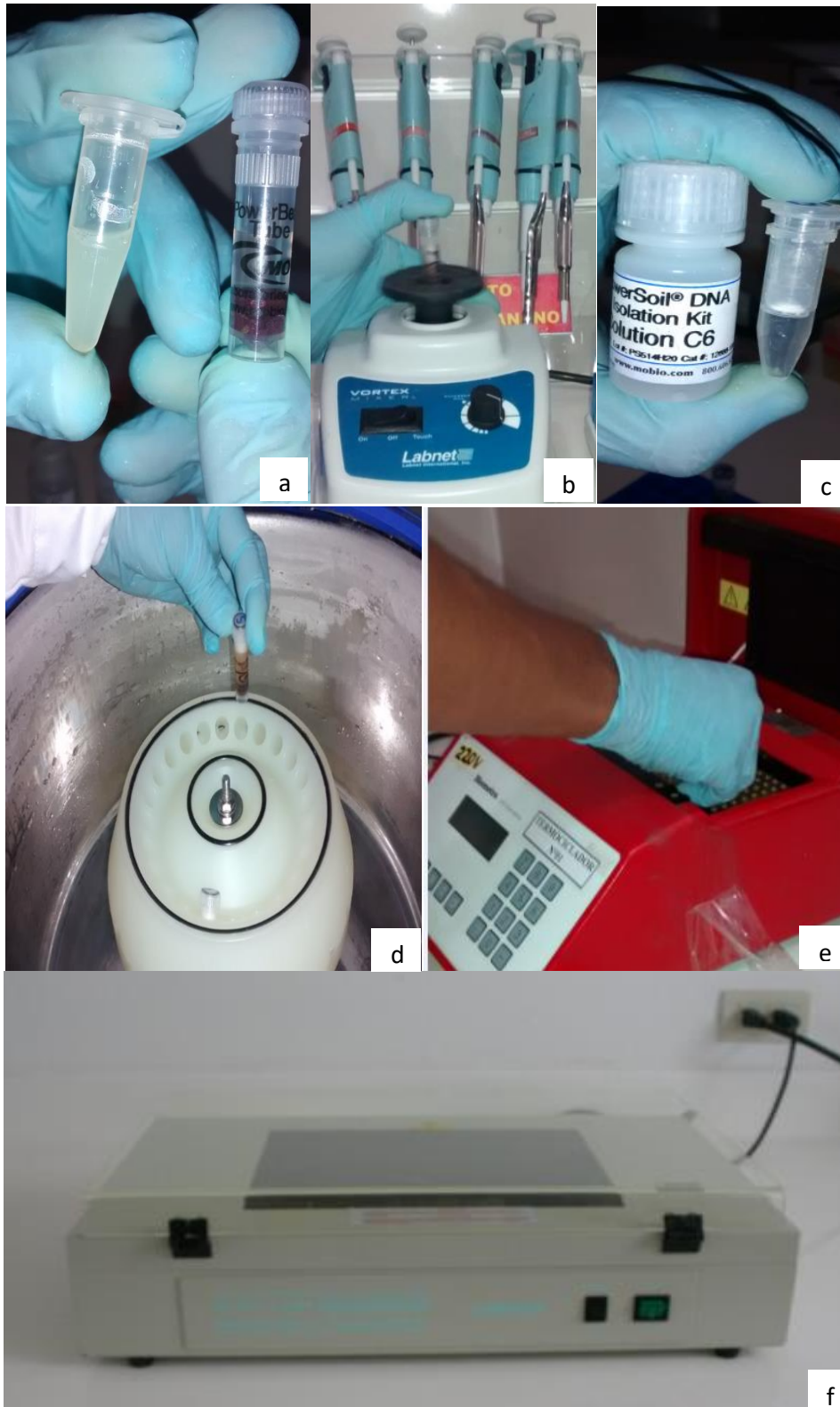
Figura 31. Materiales y equipos utilizados en el estudio: a) Micro tubo de 1.5 ml y tubo Power Bead b) Vortex y micropipetas c) Solución C6 y tubo Spin Filter d) Centrifuga e) Termociclador f) Transluminador.
