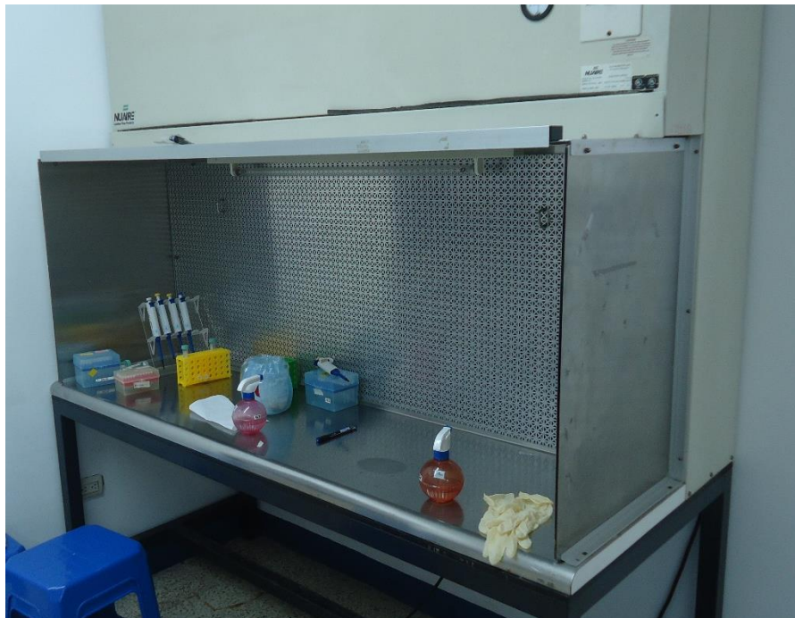
Cámara de flujo laminar
