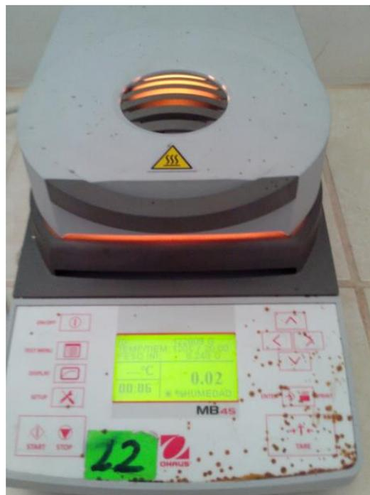
**Foto 8. Equipo medidor de humedad**
