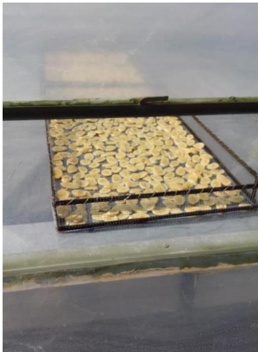
Foto 11. Secado de banano en el secador solar
