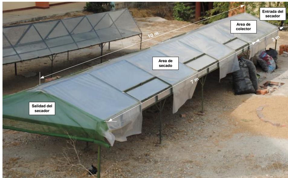
**Figura 20. Dimensiones del colector solar y el área de secado del secador**
