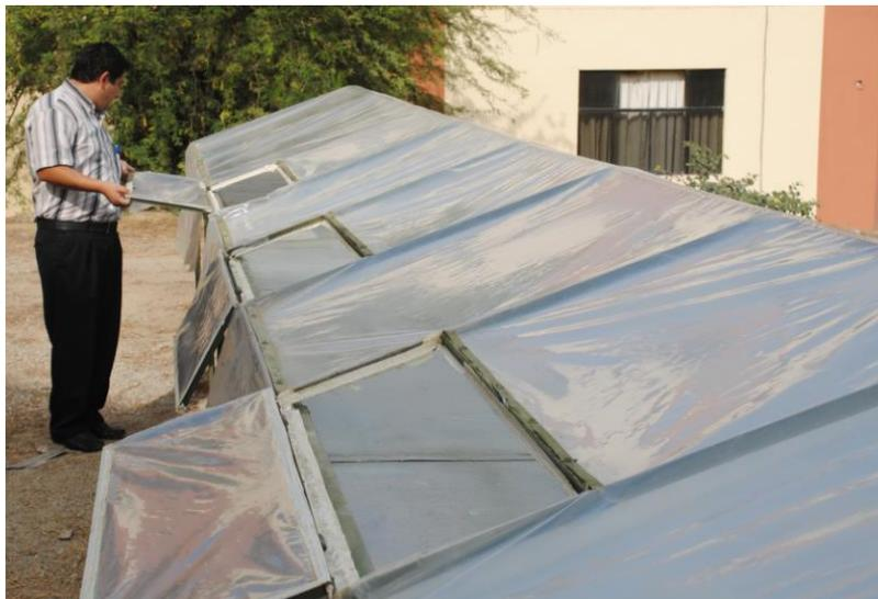
**Figura 21. Puertas de entrada de bandejas cargadas de producto al secador**
