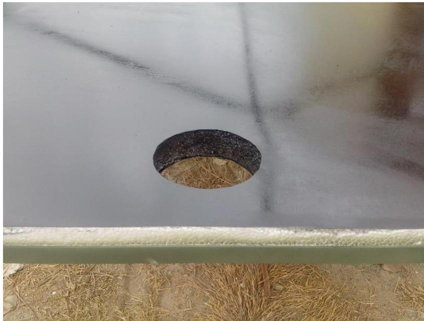
**Foto 7. Espacio para el montaje de los ventiladores**
