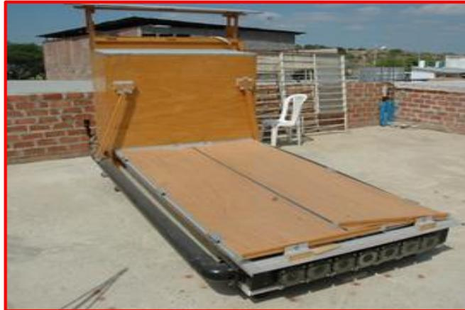
Figura 32. Vista frontal del deshidratador solar mixto cerrado.
