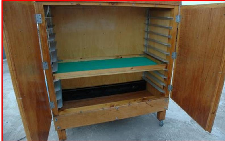
Figura 38. Vista de interior de cámara de deshidratado
