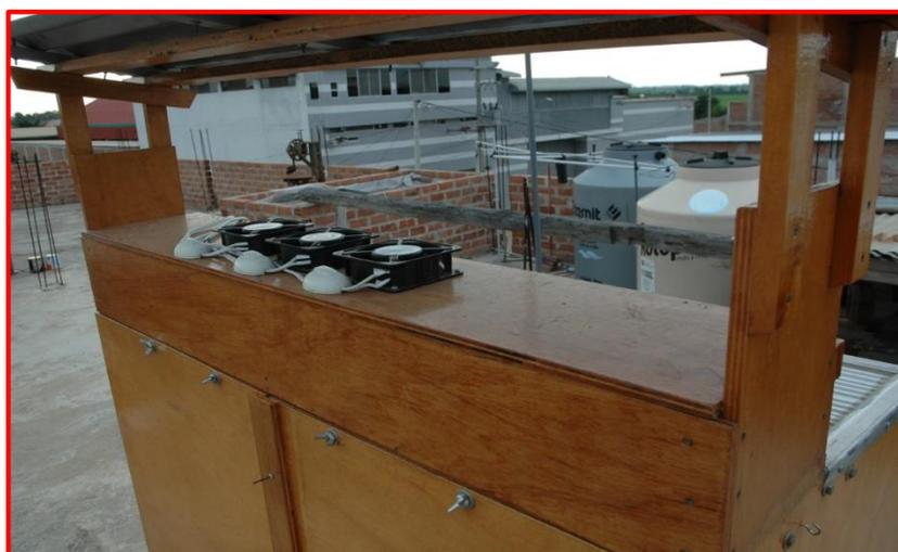
Figura 40. Extractores de aire y humedad en la chimenea
