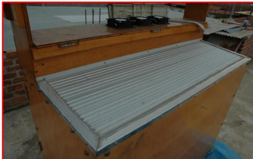
Figura 39. Compensador de calor de la parte superior de la cámara de deshidratado
