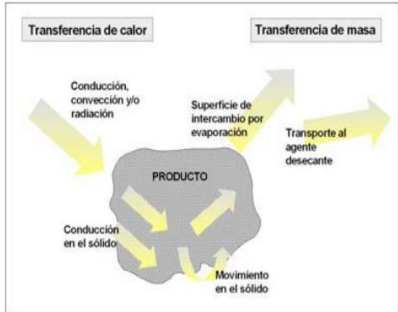
Figura 8: Transferencia del calor en el producto en un secador solar mixto.
