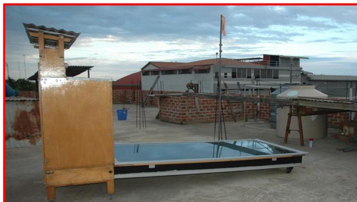
Figura 34. Vista lateral del deshidratador solar mixto expuesto al sol.
